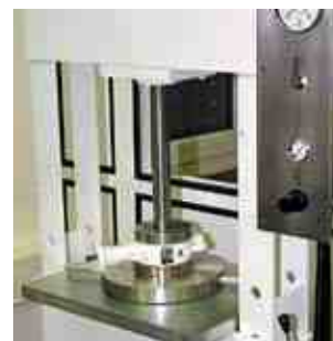
Těsnostní zkouška HP dusíkem
